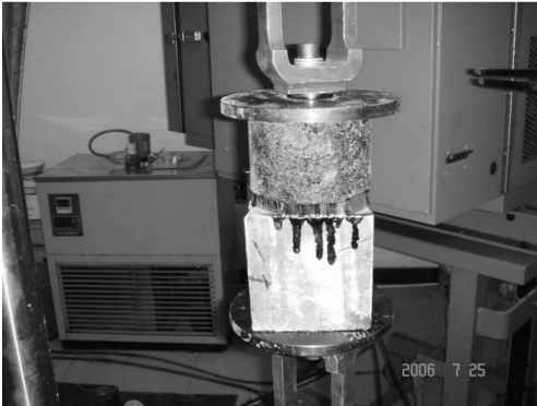
图 4 拉拔试验
