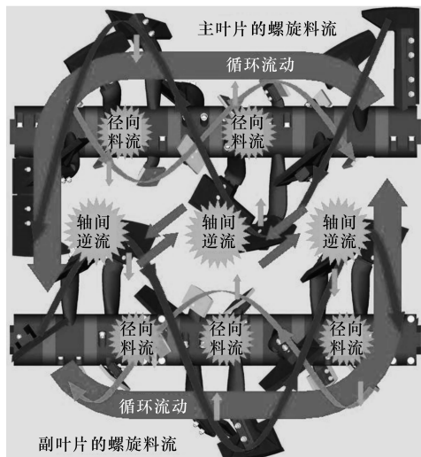
图 1 搅拌缸工作原理
