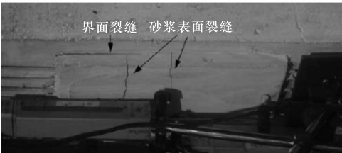
(b) 加固层剥离破坏裂缝的发展
