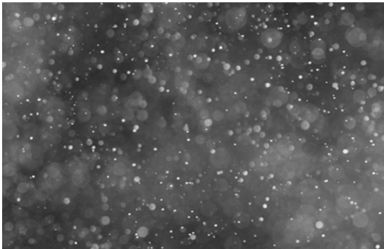
图6 喷射压力为 10 MPa 的柴油喷雾粒子
