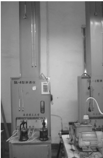
图 1 SL-4 型渗透仪
