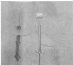
图 2 测缝计的布设
