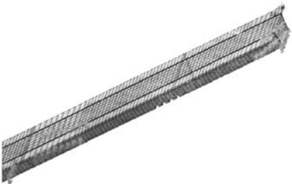
图 8 开裂后的甘洵河大桥模型
