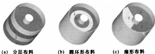
图 2 单立轴间歇式搅拌的 3 种不同布料方式
