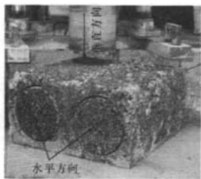
图 5 在试验板垂直方向和水平方向钻芯
