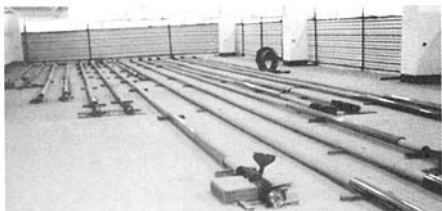
图2 制作完成后的CFRP拉索系列
