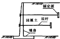
图1 悬锚式挡土墙示意图
