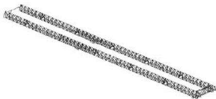
图4 主梁结构有限元模型
