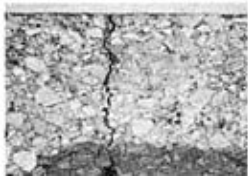
图 12 AC-10I(细级配) 的裂缝扩展线
