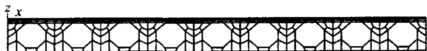
图 3 空心板桥横截面模型图
