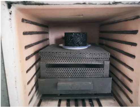
图 2 沥青混合料试件放置
