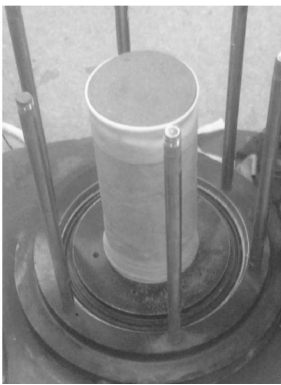
图 8 动三轴试件的安装过程 Fig. 8 Installation process of dynamic triaxial test samples
