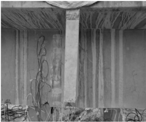
图 7 NT 梁弯曲破坏形态 Fig. 7 Flexural failure mode of girder NT
