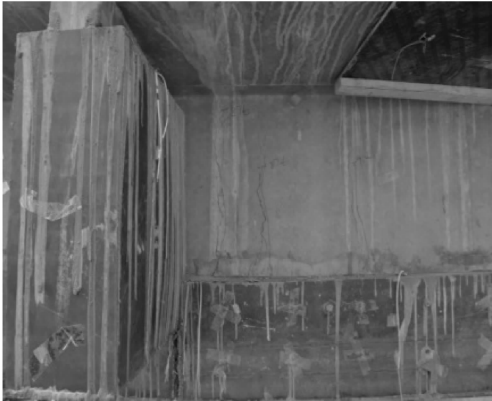
图 8 T1 梁弯曲破坏形态 Fig. 8 Flexural failure mode of girder T1
