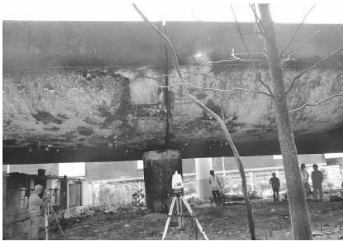
图 2 利用 3D 扫描仪扫描火灾后现场
