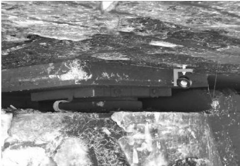
图 8 小棱镜安装实景
