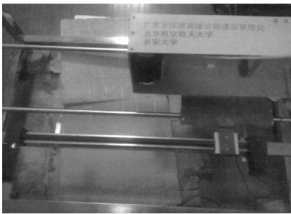
图 11 错台三维检测系统实验室试验
